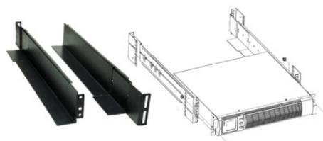
Kit de montaje de UPS en armario rack de 19" que consta de 2 soportes ajustables en longitud de 45 a 83cm, peso máximo soportado 80 kg. Se suministra con tornillos de fijación.
