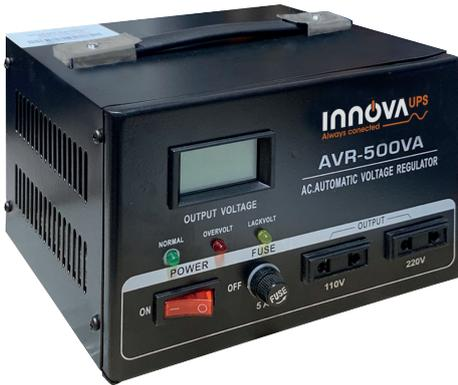
Los estabilizadores monofásicos electromecánicos de la serie AVR son equipos controlados electrónicamente por un microprocesador que nos ofrece una protección contra sobretensiones y picos muy elevados de la red eléctrica sin deformar la onda senoidal de entrada y estabilizando la tensión de salida dentro del  $\pm 3\%$  la cual es la requerida para alimentar cargas críticas.
