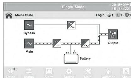
Display de manejo intuitivo y navegación a través de subcarpetas para controlar en todo momento el estado de la UPS.
