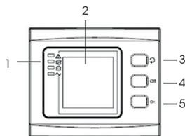
1. LED ( alarma, salida bypass, salida batería, salida de red)
